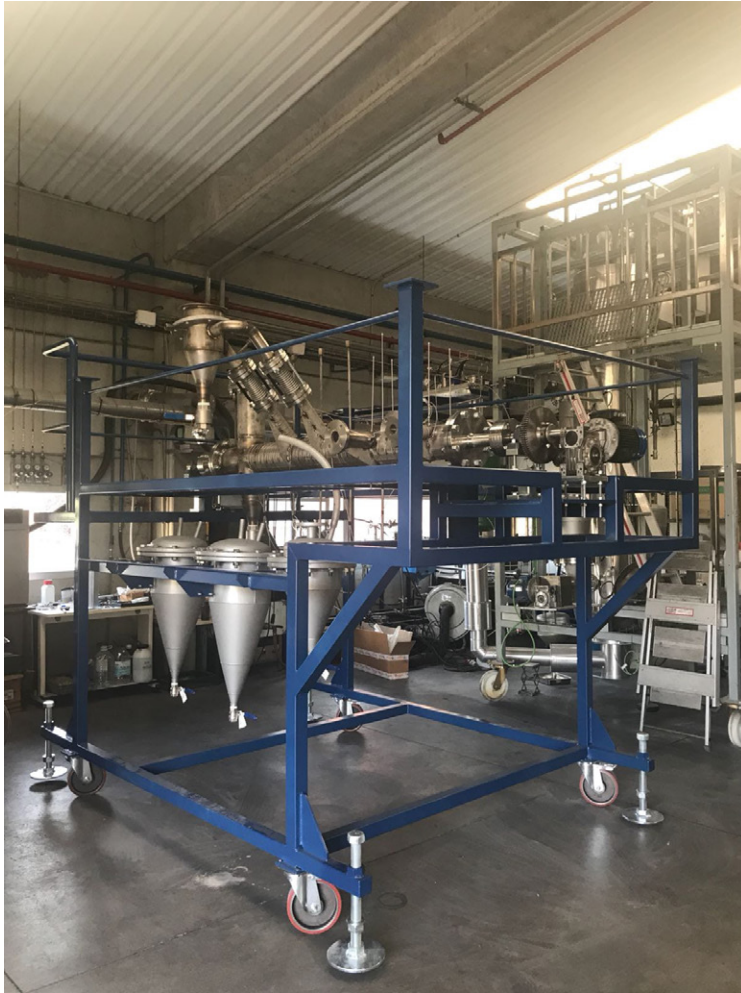
Planta piloto para la valorización mediante pirólisis de neumáticos fuera de uso. / ICB
