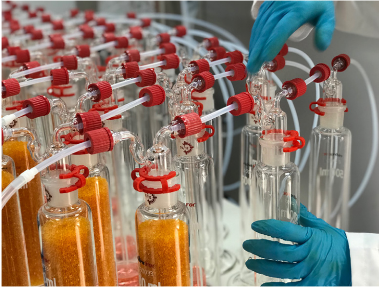
Sistema de medición gravimétrica del ensayo de biodegradación. / UNIDAD DE BIODEGRADABILIDAD Y COMPOSTABILIDAD, PTI SUSPLAST, IATA
