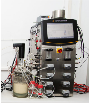
Cultivo en biorreactor de bacterias productoras de bioplástico. / CIB
