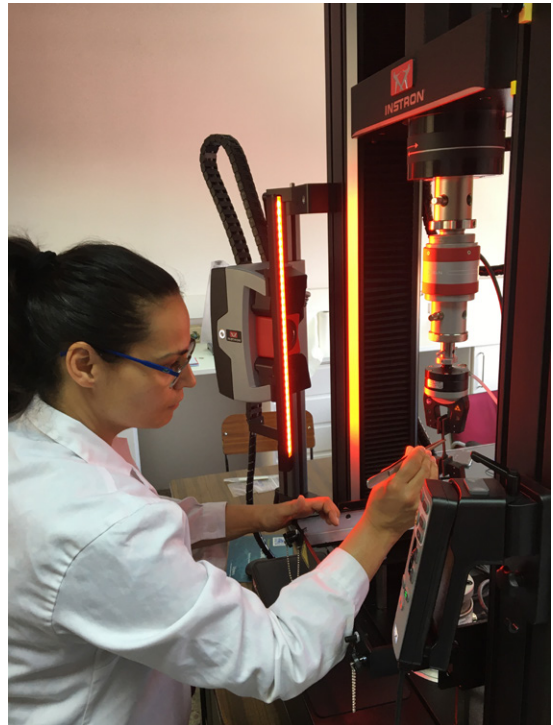
Máquina universal de ensayos mecánicos para la caracterización de materiales poliméricos.
