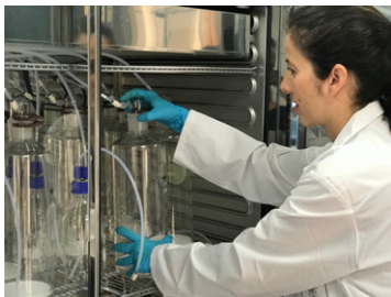
Reactores para ensayos de biodegradación en medio compost/ SUELO. / UNIDAD DE BIODEGRADABILIDAD Y COMPOSTABILIDAD, PTI SUSPLAST, IATA
